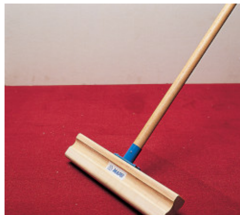
Massaggiatura dopo la posa
